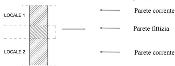
32. ponte termico è la discontinuità di isolamento termico che si può verificare in corrispondenza agli innesti di elementi strutturali (solai e pareti verticali o pareti verticali tra loro);
